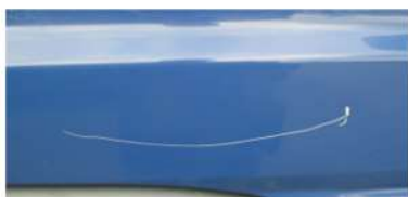
✗ Drzwi - znaczące uszkodzenia wykraczające poza normalne ślady zużycia
