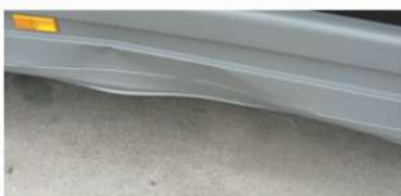
✗ Osłona podwozia zabezpieczająca przed uderzeniem bocznym – znaczące uszkodzenia wykraczające poza normalne ślady zużycia • Znaczące odkształcenia
