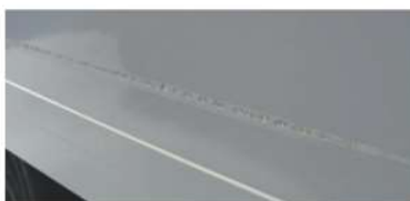
✗ Nadwozie skrzyniowe - znaczące uszkodzenia wykraczające poza normalne ślady zużycia • Znaczące otarcia lakieru aż do bazowej warstwy lakieru
