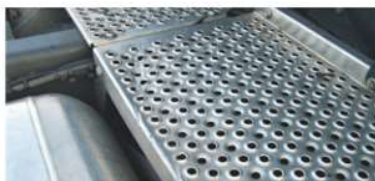
✓ Osłona ramy – ślady użytkowania • Niewielkie odkształcenia, niewielkie otarcia
