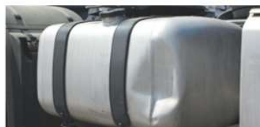
✗ Zbiornik na paliwo – znaczące uszkodzenia wykraczające poza normalne ślady zużycia • Odkształcenia
