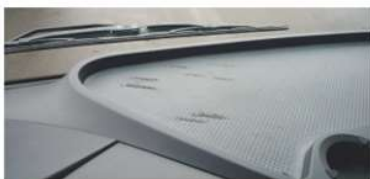
✗ Deska rozdzielcza – znaczące uszkodzenia wykraczające poza normalne ślady zużycia • Głębokie zarysowania, dziury lub przewiercenia
