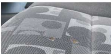
✗ Siedzenia – znaczące uszkodzenia wykraczające poza normalne ślady zużycia • Dziury i pęknięcia
