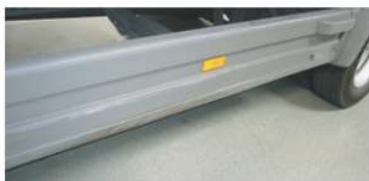
✓ Osłona podwozia zabezpieczająca przed uderzeniem bocznym – znaczące uszkodzenia wykraczające poza normalne ślady zużycia • Niewielkie otarcia
