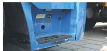
✗ Wejście - znaczące uszkodzenia wykraczające poza normalne ślady zużycia • Głębokie zarysowania, ubytki materiału lub pęknięcia
