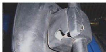
✗ Lusterko - znaczące uszkodzenia wykraczające poza normalne ślady zużycia • Głębokie zarysowania, pęknięcia materiału lub połamany materiał
