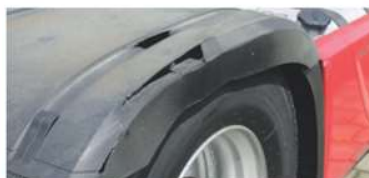
✗ Nadkole - znaczące uszkodzenia wykraczające poza normalne ślady zużycia • Dziury lub odkształcenia
