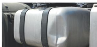
✗ Zbiornik na paliwo – znaczące uszkodzenia wykraczające poza normalne ślady zużycia • Odształcenia
