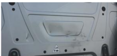
✗ Tylna ściana kabiny kierowcy - znaczące uszkodzenia wykraczające poza normalne ślady zużycia • Wgniecenia, otarcia lakieru z wgnieceniem lub pęknięciami
