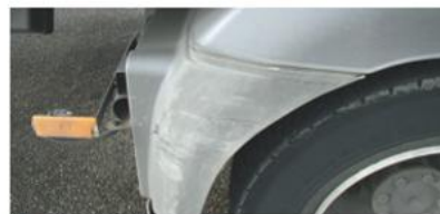
✓ Błotnik – ślady użytkowania • Niewielkie otarcia powierzchni
