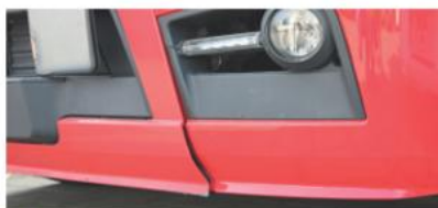
✗ Zderzak - znaczące uszkodzenia wykraczające poza normalne ślady zużycia • Duże otarcia, pęknięcia materiału lub połamany materiał
