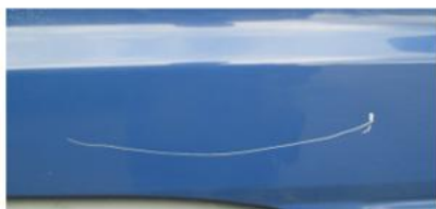
✗ Drzwi - znaczące uszkodzenia wykraczające poza normalne ślady zużycia • Znaczne otarcia lakieru
